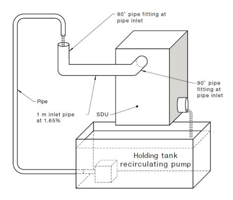
FIGURE C1 TYPICAL ENDURANCE TEST SET-UP
